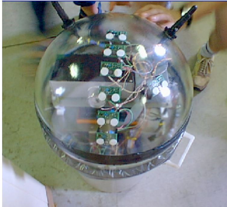
Figura 2.15: Sfera Benthos sulla cui superficie interna sono installati i fotodiodi.
