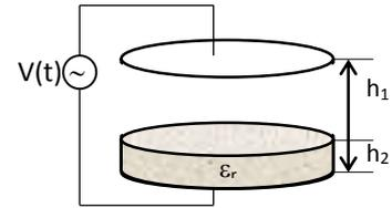
Scrivere le espressioni della densità di corrente di spostamento all'interno del condensatore e calcolarne il valore efficace.
