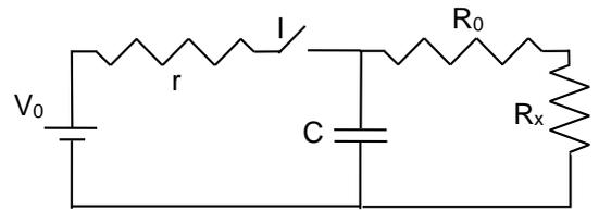
**Opzionale [+ 2punti]:** utilizzando il valore di  $R_x$  trovato calcolare il  $\tau$  del circuito.
