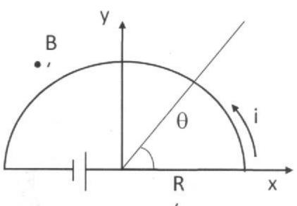
herena forsa dato che B(Y=0) = 0 Per ogni elements de delle inconferenza si esercita una forza dF=idexB [i] = i dl B(0) p L'acadinata radiale] La forsa totale sora 2 volte l'integrale dF projettata lugo l'arre / dFror=2 dF sent From = 2 [i B(0) sent dl. se dl = Rdt
