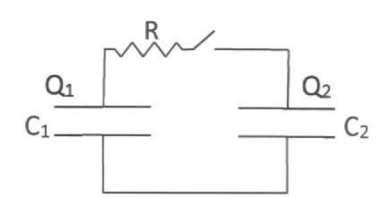
Dati:  $C_1 = 1 \mu F$ ;  $C_2 = 2 \mu F$ ;  $Q_1 = Q_2 = 2 nC$
