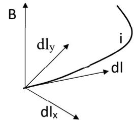
La relazione generale è:  $d\vec{F} = i d\vec{l} \times \vec{B}$ ; perpendicolare a  $B$ , quindi con componenti solo  $x$  e  $y$ .
