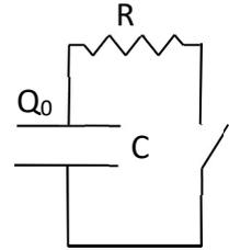
**Dati:** **C = 1 nF ; R = 1 MΩ ; Q<sub>0</sub> = 1 μC ; t\* = 1 ms.**
