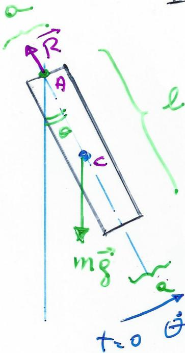
È un sistema rigido che ruota attorno al punto A in un piano verticale.
