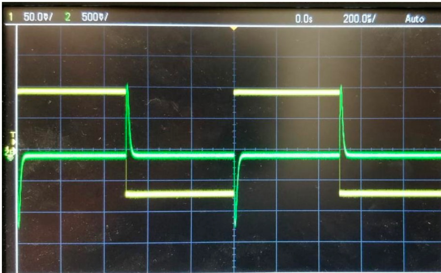
Figure 6: Visualizzazione tramite oscilloscopio dei segnali di output (verde) e input (giallo, con frequenza 1 kHz e ampiezza 80 mV).
