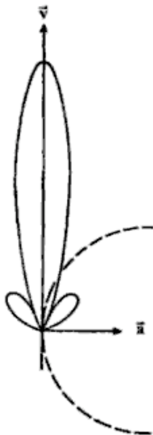
Figure 5: La distribuzione dell'energia irradiata da una carica che si muove a velocità relativistica lungo la direzione verticale, che subisce un'accelerazione lungo l'asse orizzontale.
