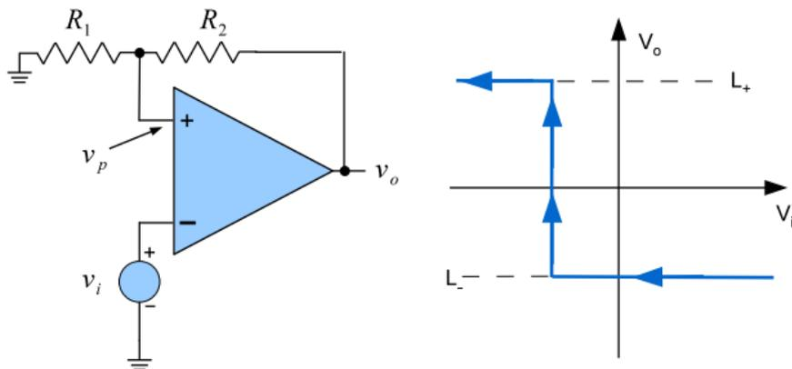
Facciamo ora diminuire  $v_i$ : l'uscita commuta dallo stato down allo stato up quando  $v_i < \beta L_-$ .
