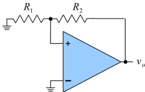
Data la reazione positiva ( $\beta = R_1/(R_1 + R_2)$ ) l'operazionale va inevitabilmente in saturazione. Due soli possibili stati stabili:
