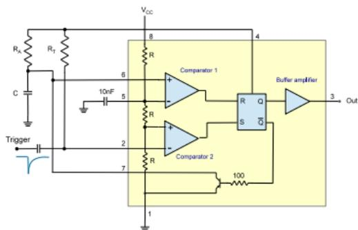
Supponiamo inizialmente  $\bar{Q} = 1$  e il condensatore C, scarico. L'uscita Q è a zero
