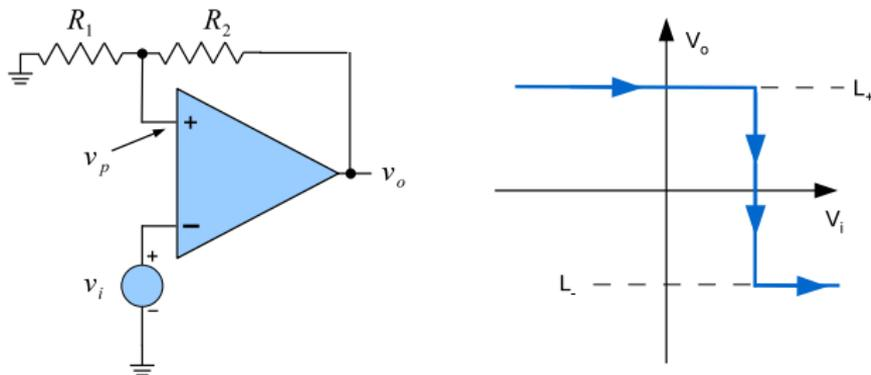
L'uscita commuta dallo stato up allo stato down quando  $v_i > \beta L_+$ .
