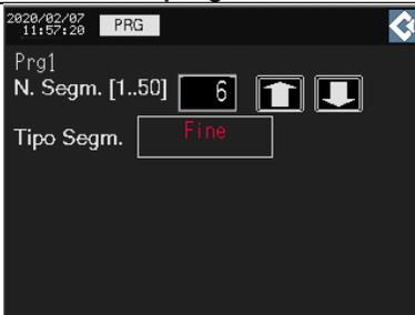
Il programma arresta la sua esecuzione, la camera interrompe il controllo della temperatura, dell'umidità e dell'illuminazione e rimane in attesa di ricevere nuove istruzioni.
