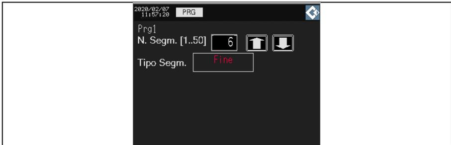
Il programma arresta la sua esecuzione, la camera interrompe il controllo della temperatura, dell'umidità e dell'illuminazione e rimane in attesa di ricevere nuove istruzioni.
