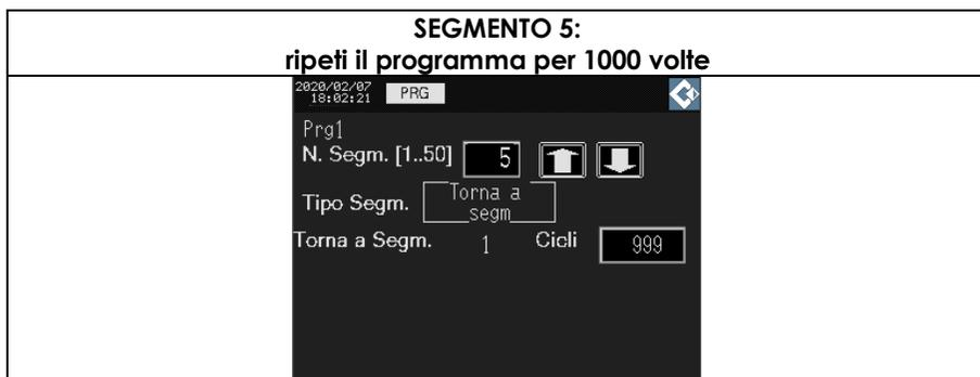
La camera riparte dal segmento 1 ripetendo il programma per altre 999 volte. In totale il programma viene così ripetuto 1000 volte (la prima volta più le 999 ripetizioni). Volendo aumentare il tempo di esecuzione è possibile impostare il segmento 6 identico al segmento 5. In questo modo il programma verrà ripetuto per 1.000.000 di volte.
