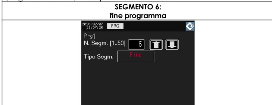
Il programma arresta la sua esecuzione, la camera interrompe il controllo della temperatura, dell'umidità e dell'illuminazione e rimane in attesa di ricevere nuove istruzioni.
