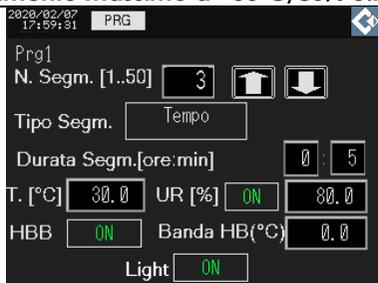
Avendo impostato ad ON la funzione HBB il controllore mette in pausa il segmento fino a quando la temperatura non avrà raggiunto il valore di 30°C.
