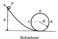
Procedimento 1: Conservazione energia. L'energia si conserva perché non siamo in presenza di forze dissipative. In particolare, possiamo eguagliare l'energia iniziale (solo potenziale, in quanto il corpo parte da fermo) con l'energia meccanica totale nel punto D:
