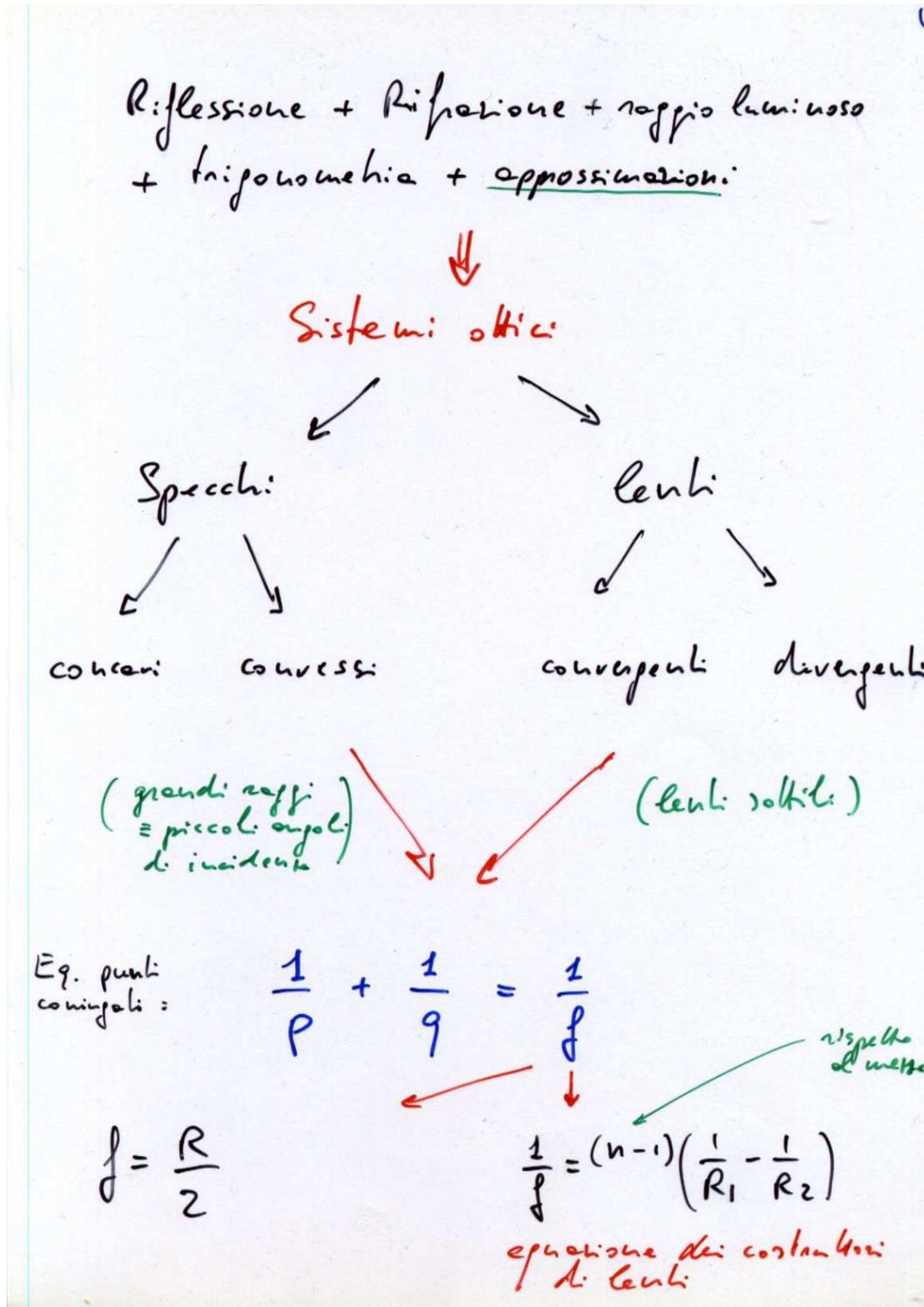
Figura 4.19: Schema generale dei sistemi ottici elementari.
