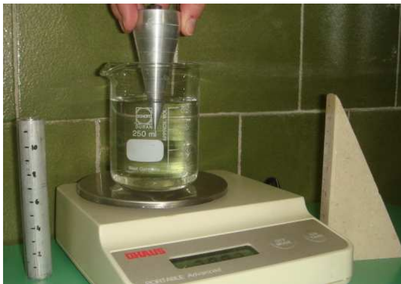
Figura 2.32: Misura della reazione alla spinta di Archimede
