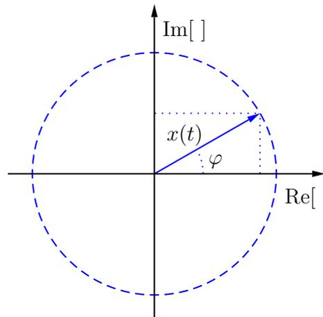
Figura 7.17: Rappresentazione di un numero complesso sul piano complesso. In particolare, figura mostra il caso in cui il modulo è costante e la fase ( $\varphi$ ) varia con il tempo.
