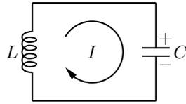
Figura 10.11: Circuito LC ideale, analizzato sotto l'ipotesi che il condensatore sia inizialmente carico.
