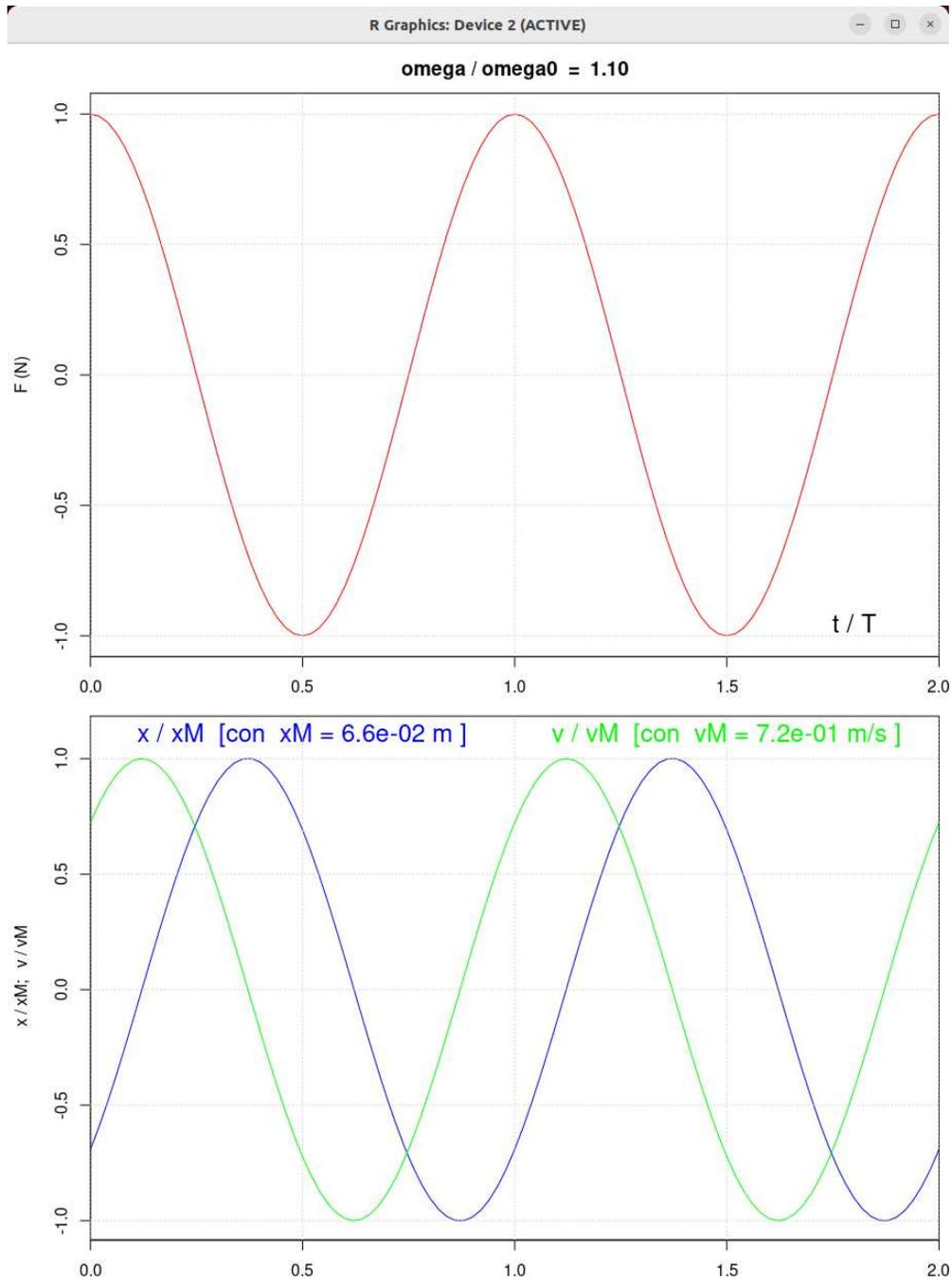
Figura 4: In alto la forza sinusoidale, avente  $\omega = 1.1 \times \omega_0$ . In basso  $x(t)$  e  $v(t)$ , con i valori riscalati ai loro massimi ( $x_M$  e  $v_M$  sopra le due curve nel plot).
