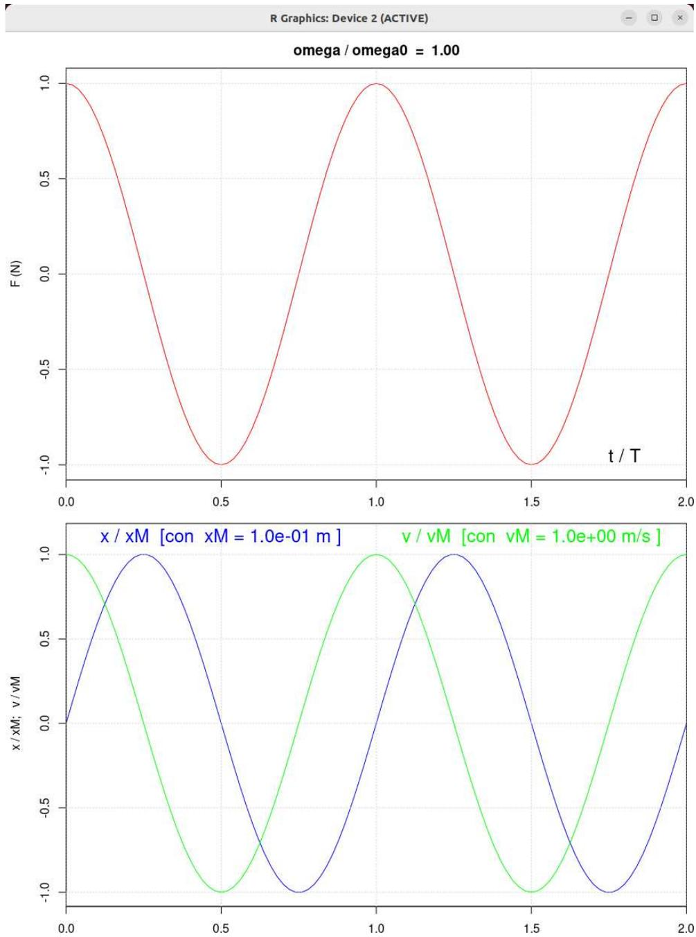
Figura 3: In alto la forza sinusoidale, avente  $\omega = \omega_0$ . In basso  $x(t)$  e  $v(t)$ , con i valori riscalati ai loro massimi ('xM' e 'vM' sopra le due curve nel plot).
