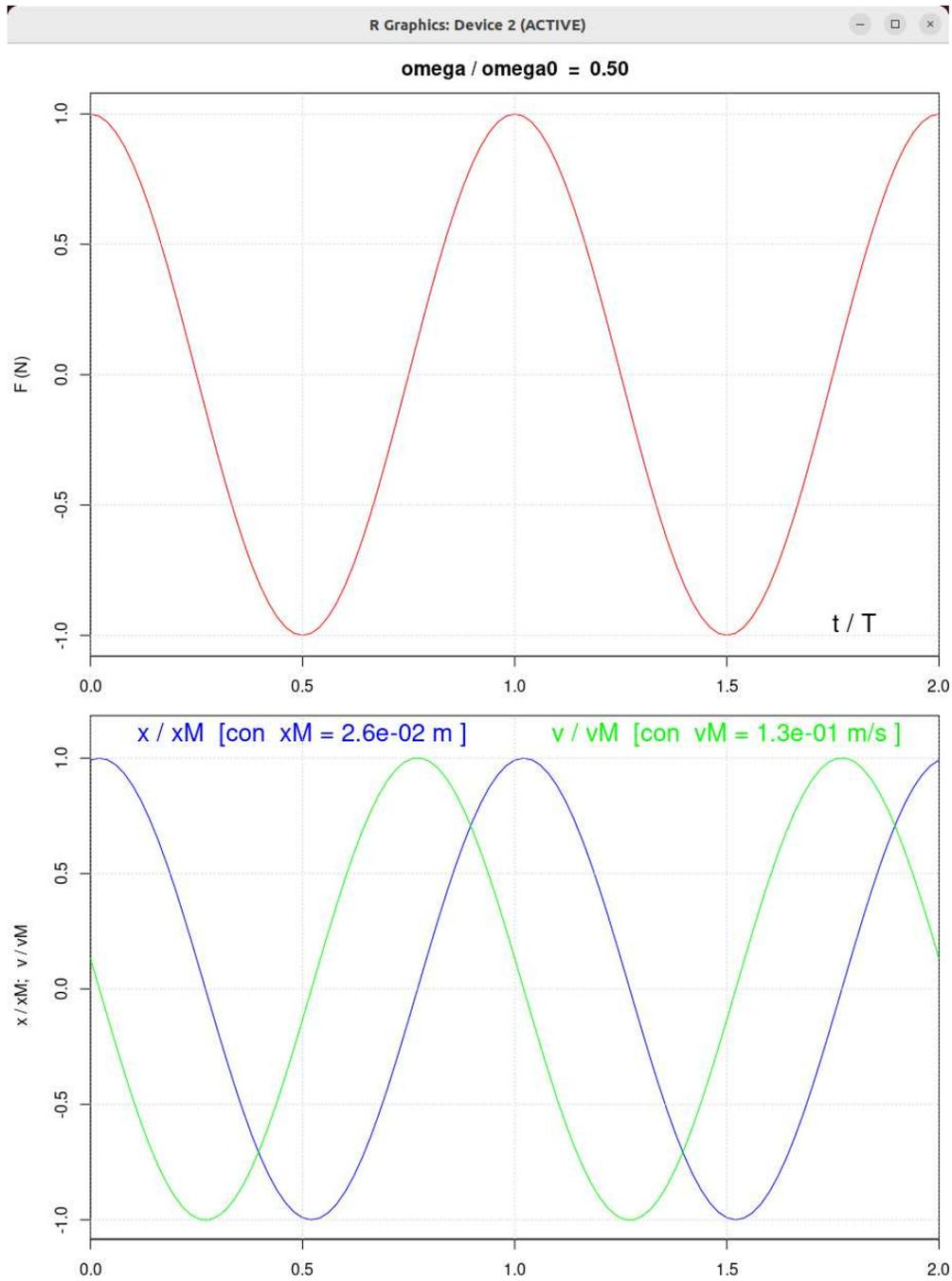
Figura 1: In alto la forza sinusoidale, avente  $\omega = \omega_0/2$ . In basso  $x(t)$  e  $v(t)$ , con i valori riscaldati ai loro massimi ( $x_M$  e  $v_M$  sopra le due curve nel plot).
