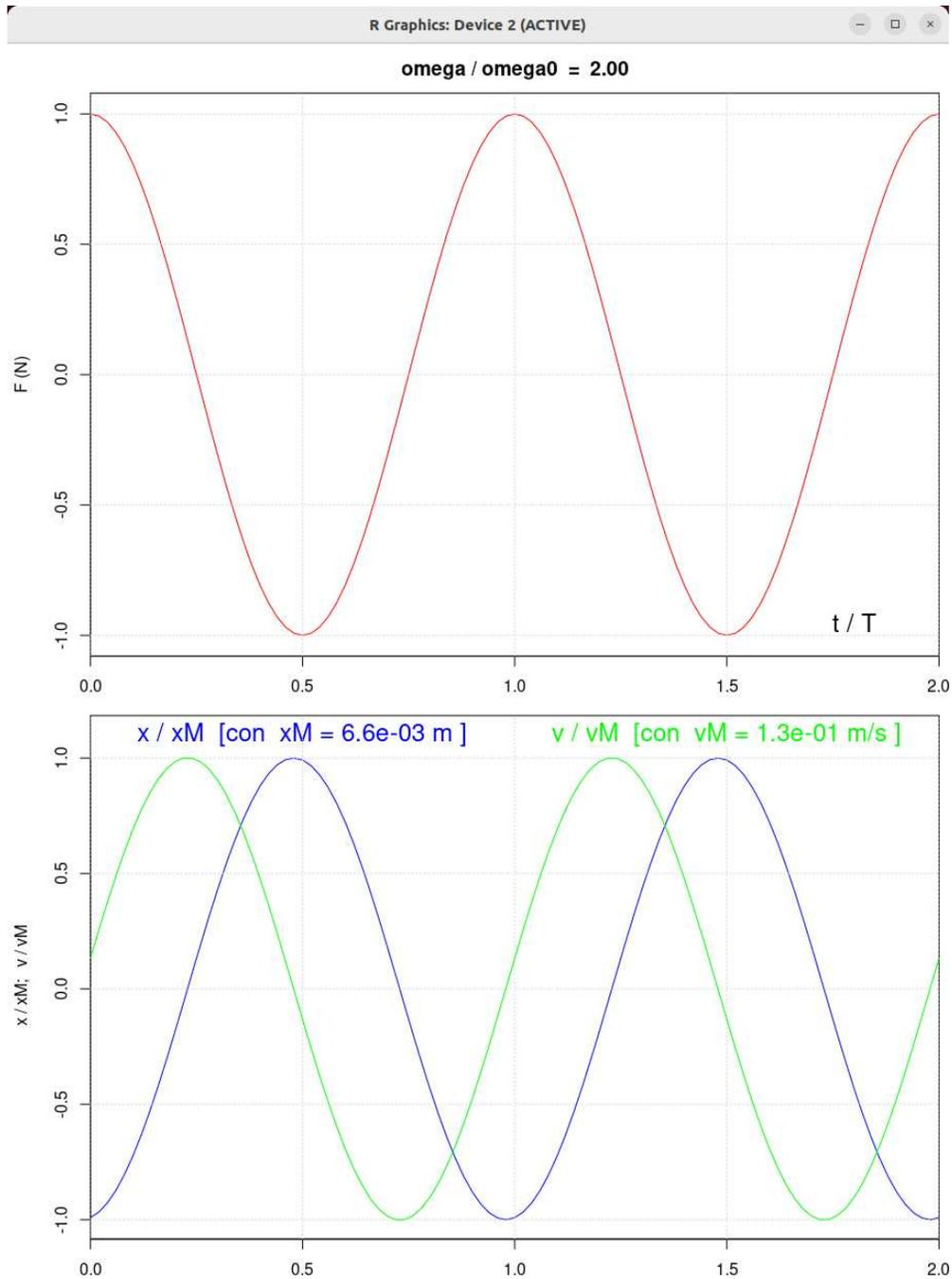
Figura 5: In alto la forza sinusoidale, avente  $\omega = 2 \times \omega_0$ . In basso  $x(t)$  e  $v(t)$ , con i valori riscaldati ai loro massimi ( $x_M$  e  $v_M$  sopra le due curve nel plot).
