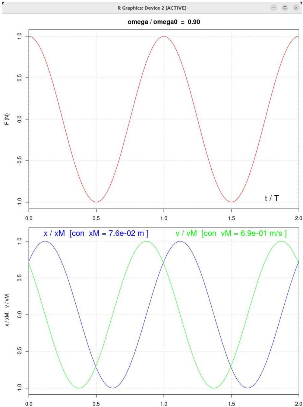
Figura 2: In alto la forza sinusoidale, avente  $\omega = 0.9 \times \omega_0$ . In basso  $x(t)$  e  $v(t)$ , con i valori riscaldati ai loro massimi ( $x_M$  e  $v_M$  sopra le due curve nel plot).
