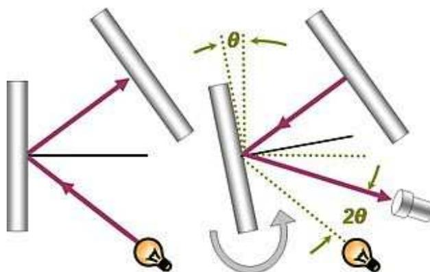
Figura 4.6: Esperimento di Foucault per la determinazione della velocità della luce ([http://en.wikipedia.org/wiki/Fizeau-Foucault\\_apparatus](http://en.wikipedia.org/wiki/Fizeau-Foucault_apparatus)).
