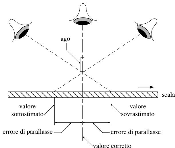
Figura 4.3: Errore di parallasse. La figura mostra la diversa lettura che si ottiene osservando la scala dello strumento da angolazioni diverse. Gli strumenti di precisione hanno una porzione della scala riflettente allo scopo di minimizzare tale effetto.
