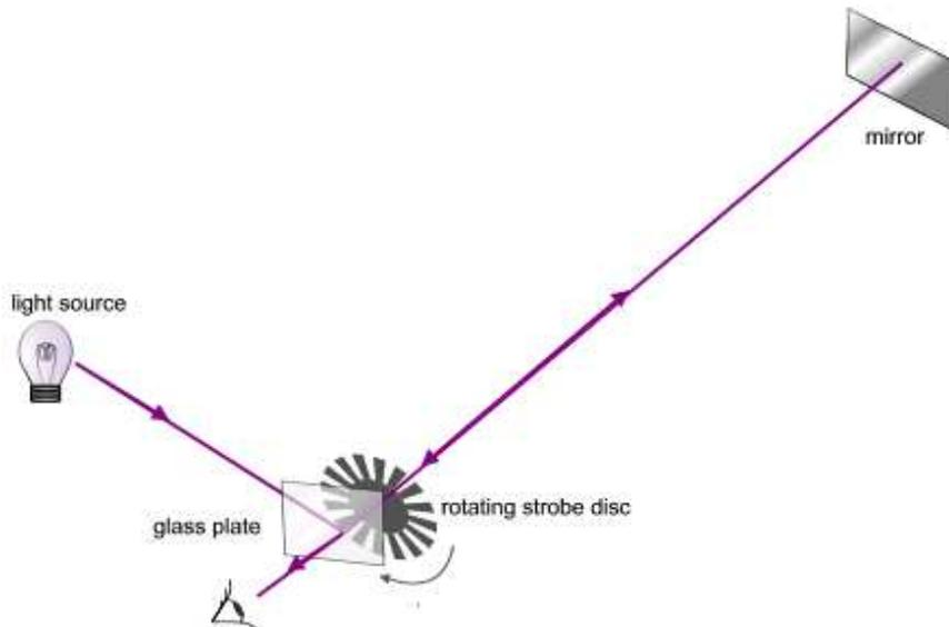
Figura 4.5: Esperimento di Fizeau per la determinazione della velocità della luce (schema concettuale da [http://commons.wikimedia.org/wiki/File:Speed\\_of\\_light\\_%28Fizeau%29.PNG](http://commons.wikimedia.org/wiki/File:Speed_of_light_%28Fizeau%29.PNG) – sicuramente non usava moderne lampadine ad incandescenza). Lo specchio semiriflettente è un espediente per avere sorgente e occhio dell'osservatore allineati lungo la direzione di propagazione della luce.
