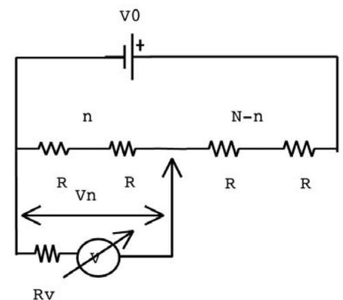
Misurare la tensione fra il polo negativo del generatore ed i primi  $n$  resistori della serie, con  $n=1,2,\dots,10$ . Effettuare le misure utilizzando:
