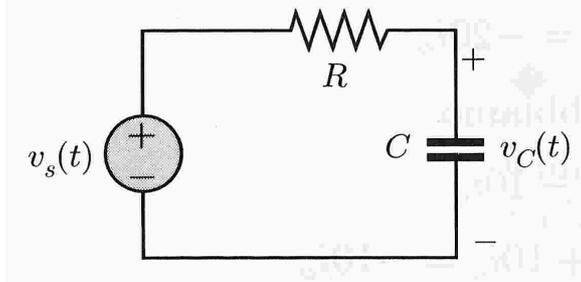
Utilizzando il multimetro digitale misurare la tensione ai capi del condensatore in funzione del tempo (una misura ogni 5 s è sufficiente) durante la carica e, successivamente, durante la scarica. Si esegua la scarica in due modalità: a) spegnendo il generatore; b) staccando il circuito dal generatore. (Non è necessario eseguire le misure durante la seconda carica. È invece importante avere pazienza ed attendere che il condensatore sia ben carico).
