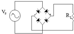
Raddrizzatore a doppia semionda (ponte a diodi)
