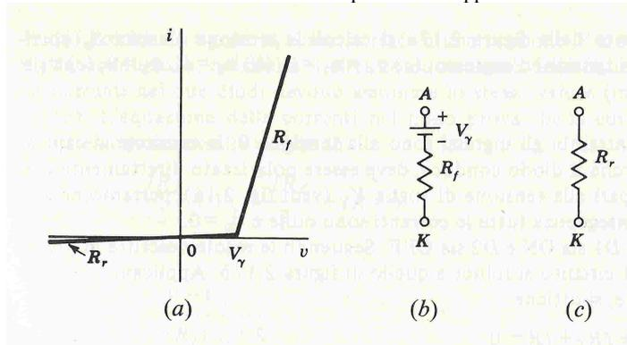
figura (b): modello del diodo in conduzione:  $v > V_\gamma$  ( $v$  e' la tensione dell'anodo A rispetto al catodo K);
