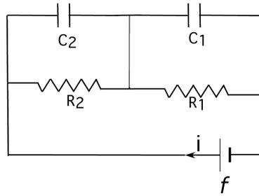
In condizioni di assoluta stazionarietà si ha moto di carica solo attraverso le due resistenze in serie  $R_1$  e  $R_2$ . Ne consegue che la corrente elettrica  $I$  è
