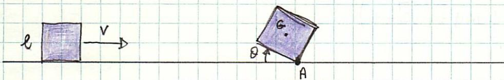
A causa del vincolo al cubo viene impresa una rotazione attorno allo spigolo A
