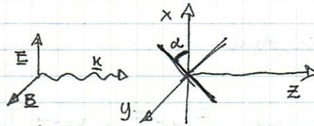
sia  $\alpha$  l'angolo tra l'asse di trasmissione del polaroid e l'asse di oscillazione del campo elettrico
